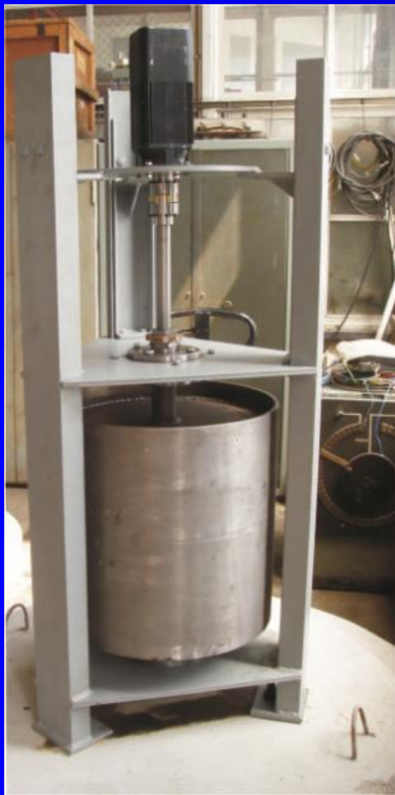
Stanowisko badawcze wirującego zasobnika energii z maszyną BLPMDCM wykonane w laboratorium Katedry Automatyki Napędu i Urządzeń Przemysłowych AGH w Krakowie
