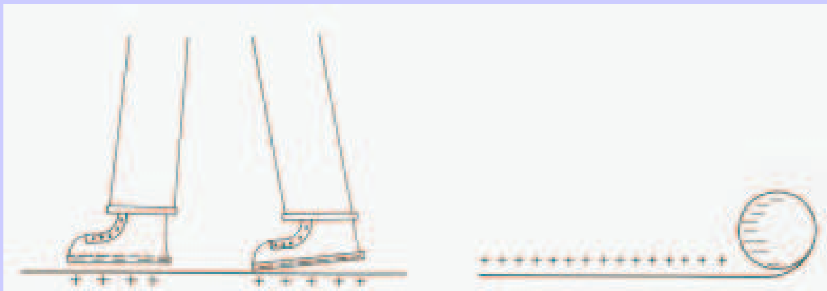
Rys.8. Powstawanie ładunków podczas chodzenia po wykładzinie izolacyjnej
